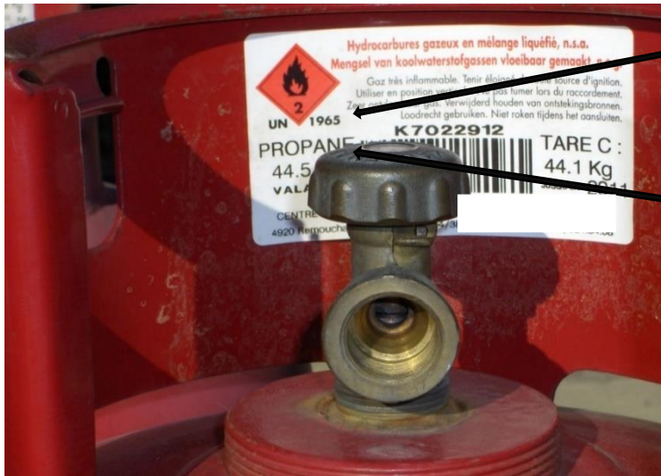
Voorbeeld van de aanduidingen op een hervulbare gasfles
